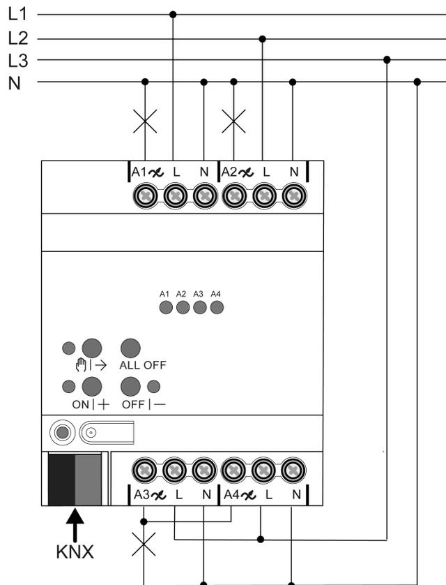
Bild 4: Geräteanschluss Komfort-Variante mit parallelgeschalteten Dimmausgängen (Anschlussbeispiel)
