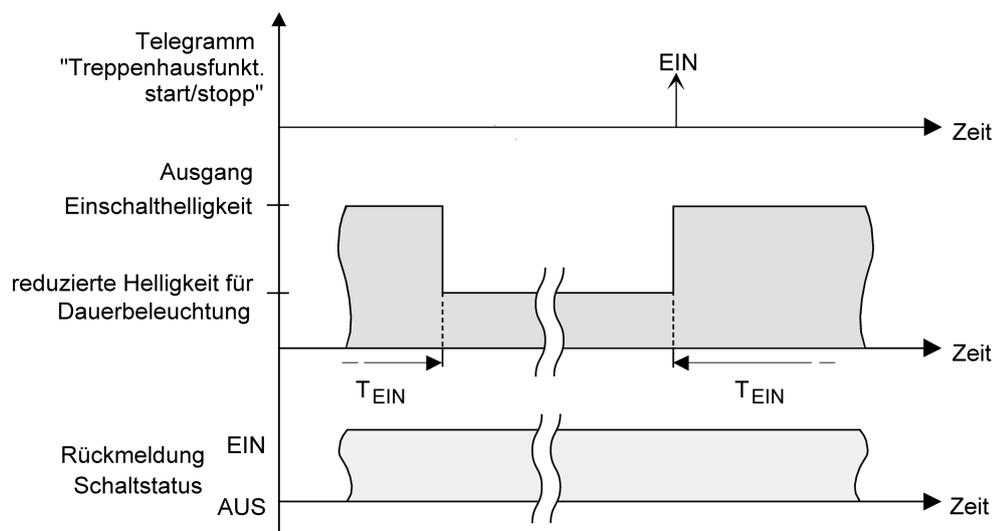
Bild 22: Die Dauerbeleuchtung der Treppenhausfunktion ohne Soft-Funktionen
