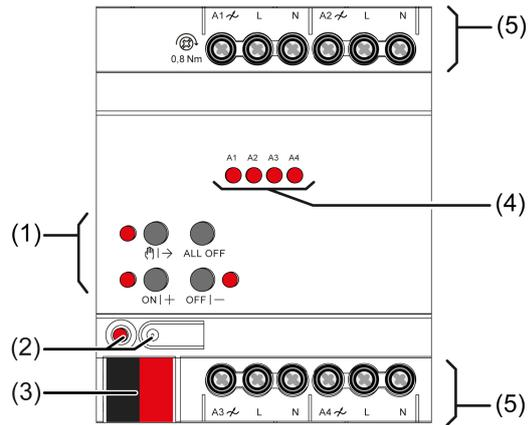
Bild 1: Geräteaufbau
