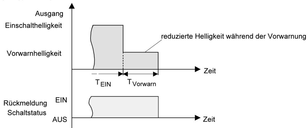
Bild 20: Die Vorwarnfunktion der Treppenhausfunktion ohne Soft-AUS-Funktion
