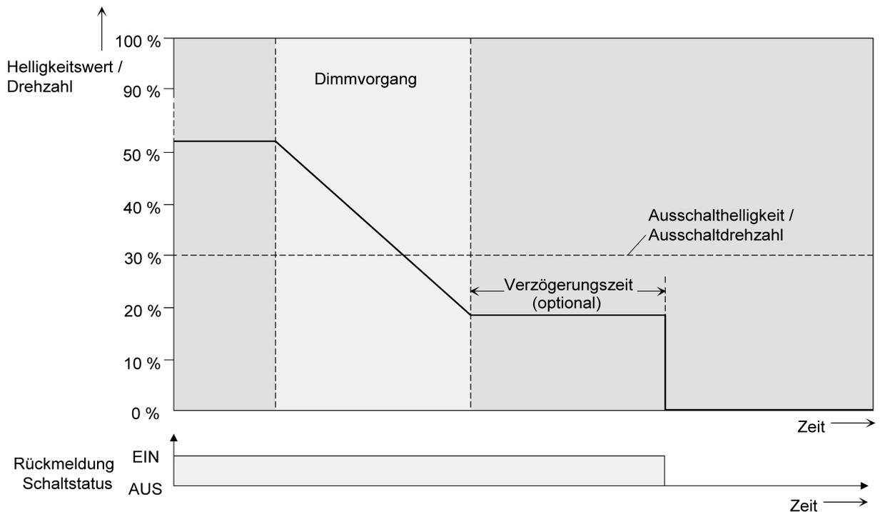
Bild 15: Dimm- und Schaltverhalten der automatischen Ausschaltfunktion
