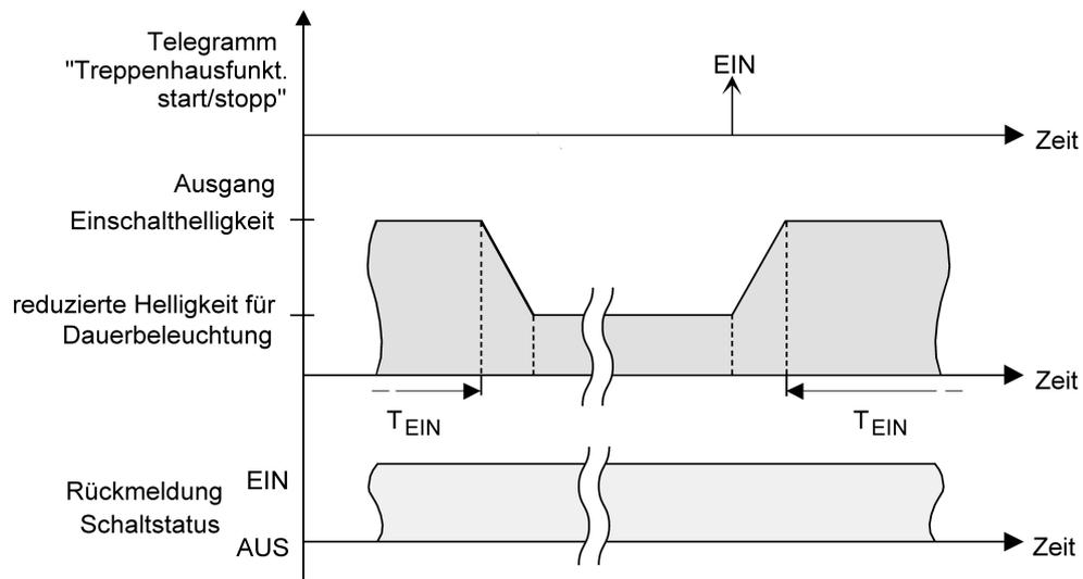
Bild 23: Die Dauerbeleuchtung der Treppenhausfunktion mit Soft-AUS-Funktion
