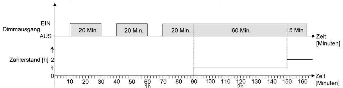
Bild 26: Funktionsweise des Betriebsstundenzählers (am Beispiel gezählter Stunden)
