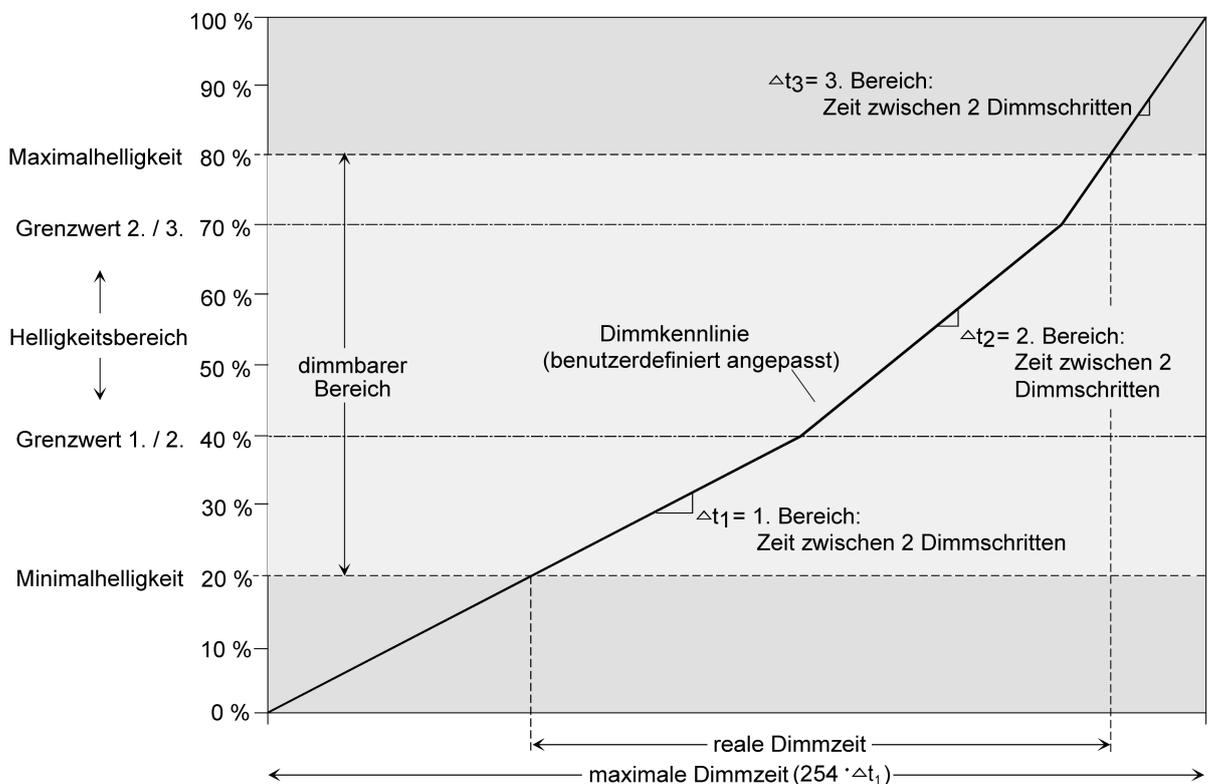
Bild 10: Benutzerdefinierte Dimmkennlinie als Beispiel mit Minimalhelligkeit und
