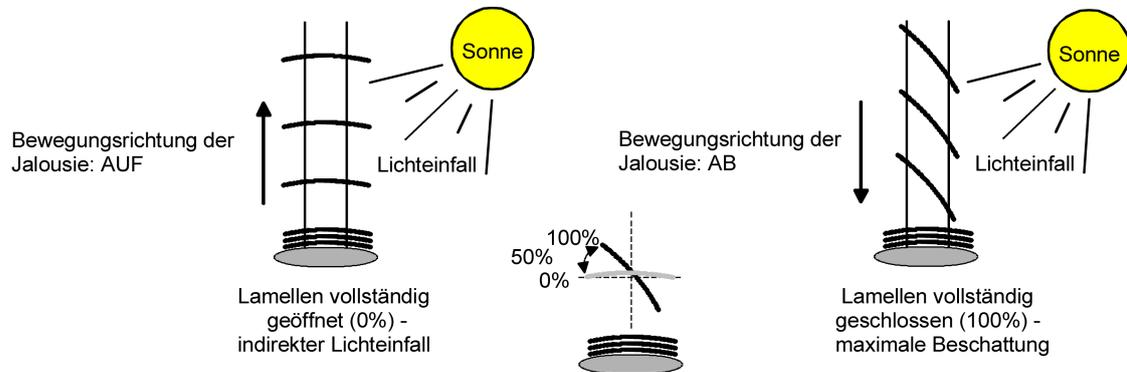
Bild 7: Typ 2 - Lamellenjalousien mit schräger und gerader Lamellenstellung
