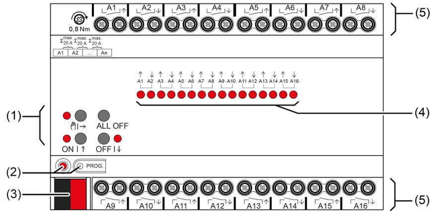
Bild 1: Geräteaufbau
