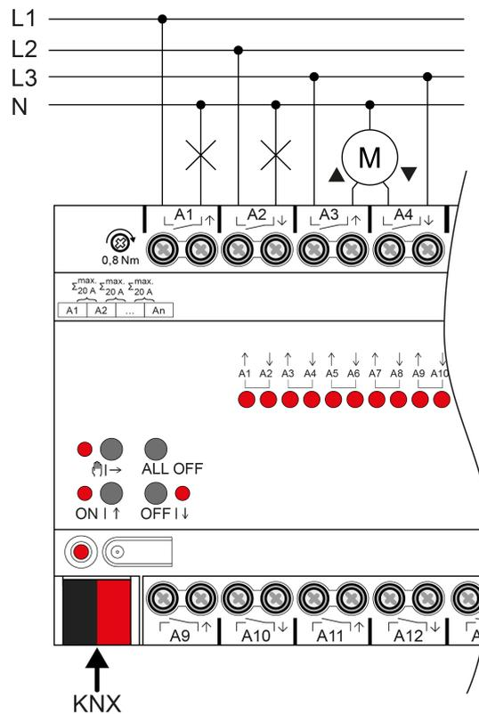
Bild 2: Geräteanschluss (Anschlussbeispiel)
